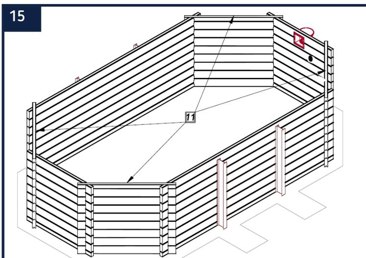
Positionnez ensuite les demi madrier supérieurs (11) aux endroits indiqués sur le schéma ci-dessus. En cas de besoin, utilisez la cale en bois pour les encastrer correctement.
