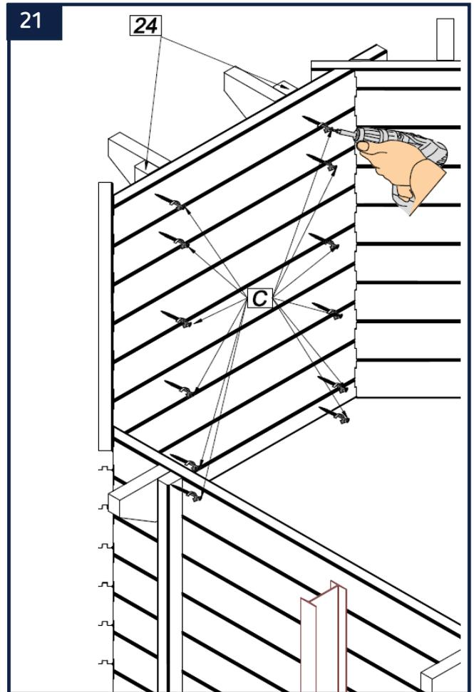
Identifiez à l'aide du schéma page 26 la disposition des renforts verticaux (24) tout autour de la piscine. Attention, ces derniers doivent être situés à l'extérieur du bassin.
