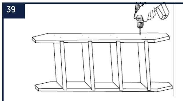
**39** Une fois les trous indiqués, percez-les à l'aide d'une perceuse équipé d'un foret de 3 mm.
