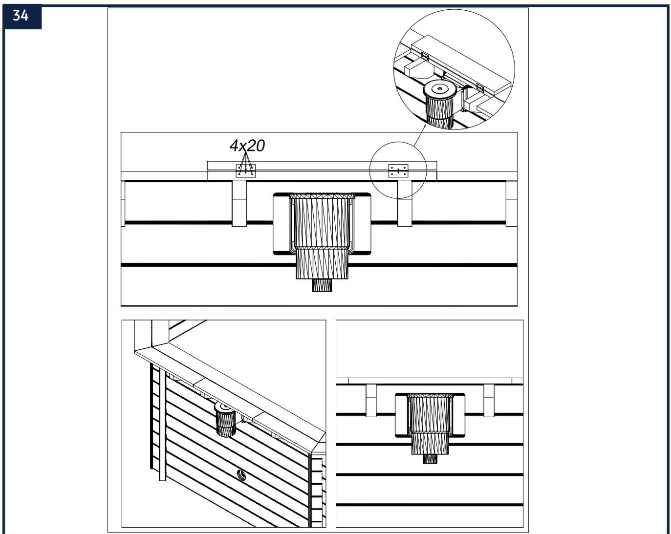
Fixez, à l'aide des vis 4 x 20 mm (J), les charnières (A) sur la tranche de la margele amovible (20) et la tranche de la margele intérieure (17) positionnée au niveau du skimmer comme indiqué sur le schéma ci-dessus.
