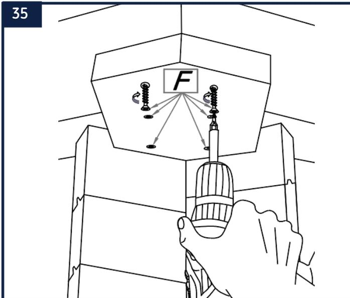
Fixez les jonctions (28) à l'aide des vis 4 x 40 mm (F) en prenant soin d'attraper chacune des 4 margelles comme indiqué sur le schéma ci-contre.
