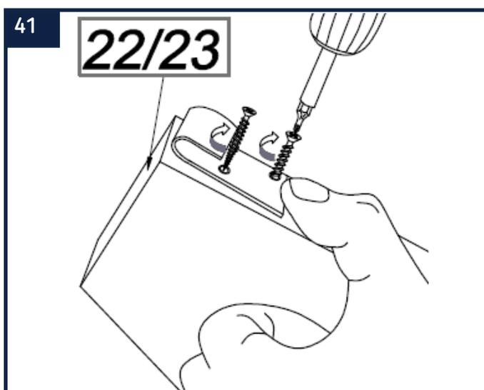
Fixez les boucles de l'échelle (B1) sur les limons gauche (22) et droit (23) de l'échelle à l'aide des vis 4 x 40 mm (F).
