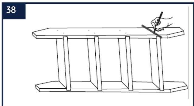
**38** Utilisez une règle et un crayon de papier pour indiquer l'emplacement des trous qui permettront de fixer les marches.
